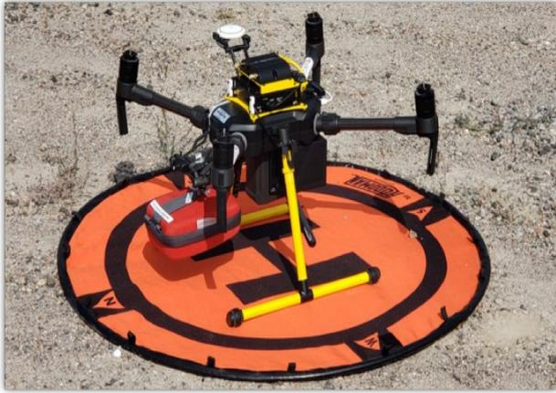
**Figure 2** - Drone équipé d'un défibrillateur automatisé externe
